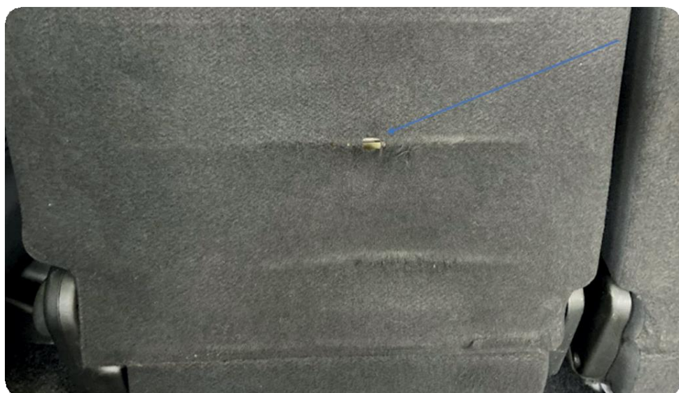
Non toléré - Housse de siège endommagée
