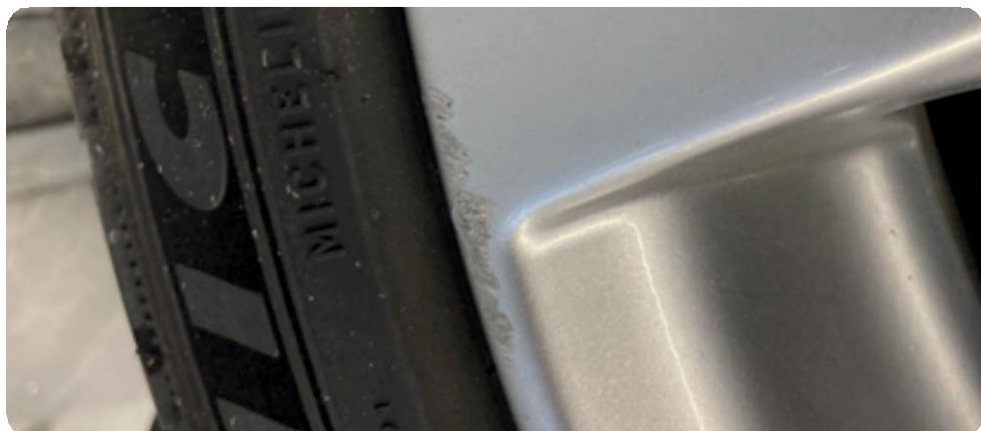
Toléré - jante légèrement endommagée
