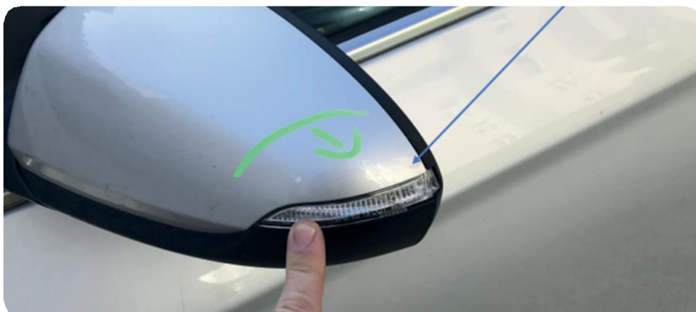
Non toléré - vitre du clignotant fissurée
