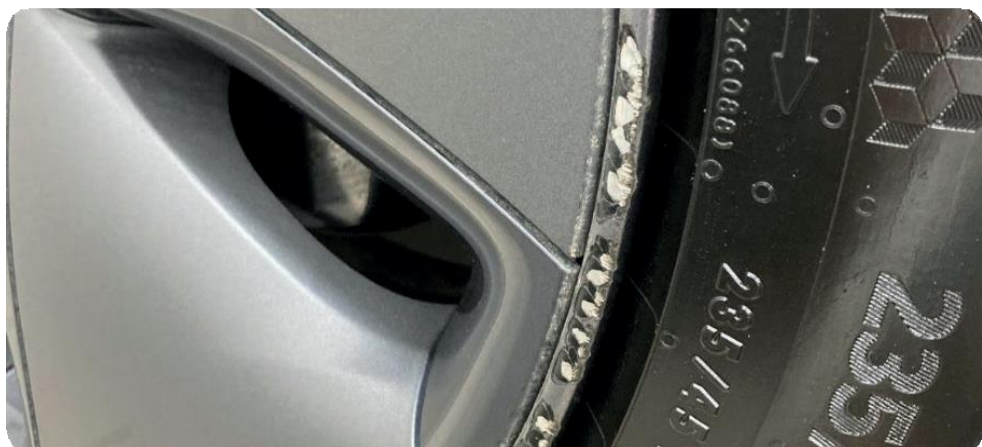
Non toléré - jante fortement endommagée
