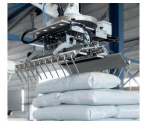
Der Hochleistungs-Roboter-Palettierer PRINCIPAL-R, ein Knickarm-Robotpalettier-System, wird stets als kunden-spezifische Lösung mit namhaften Industrieroboter-Herstellern und dem STATEC BINDER Know How angeboten. Eine Besonderheit des PRINCIPAL-R ist, dass er für sogenannte Sling Bags optimiert wurde.
