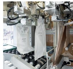
Полностью автоматическая упаковочная машина SYSTEM-T с технологией FFS сочетает в себе высочайшее качество упаковки в мешки из полиэтиленового рукава с высокой производительностью и поэтому идеально подходит для использования в самых разных сферах, таких как нефтехимия, производство удобрений, кормов для животных, продуктов питания и т. д.
