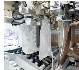
La máquina de ensacado totalmente automático FFS SYSTEM-T combina la más alta calidad de ensacado para sacos tubulares de PE con una elevada capacidad de producción. Además, es perfecta para su uso en diversas áreas, como en la industria petroquímica o en la de los fertilizantes, forrajes, alimentos, etc.
