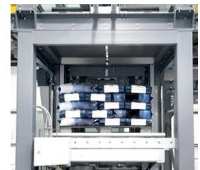
Der Hochleistungs-Hochlagenpalettierer PRINCIPAL-H stapelt pro Stunde bis zu 2400 Säcke oder Kartons.
