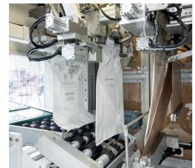
La machine d'emballage FFS automatique SYSTEM-T allie une qualité d'emballage optimale pour les sacs en polyéthylène à partir de tuyaux et une capacité de production élevée. Elle est ainsi idéale pour une utilisation dans des domaines variés tels que la pétrochimie, les engrains, l'aliment pour animaux, les denrées alimentaires, etc.
