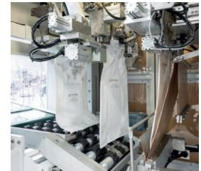
Die vollautomatische FFS-Verpackungsmaschine SYSTEM-T kombiniert höchste Verpackungsqualität für PE-Säcke vom Schlauch mit einer hohen Produktionskapazität und ist daher ideal zur Verwendung in den verschiedensten Bereichen wie z.B. Petrochemie, Düngemittel, Tierfutter, Lebensmittel, etc.
