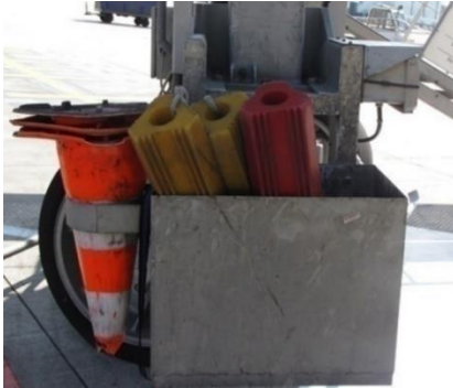
Fig. 34. Opbergplaats voor kegels en blokken op pier A
