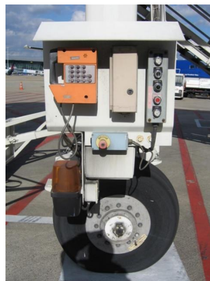
Fig. 50. Arrêt d'urgence externe du boarding bridge jetée B
