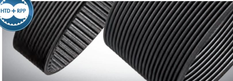
Der Zahnriemen **optibelt OMEGA RB** mit zusätzlichem PK-Keilrippenriemen-Profil auf der Rückseite des Riemen ermöglicht Riemenschlupf, wenn der Antrieb blockiert und abrupt stoppt. Der Optibelt-Antriebsriemen schützt die wertvollen Antriebskomponenten und ermöglicht einen Neustart, sobald die Sperre aufgehoben wird.
