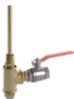
Magnetická vložka pre oddelenie ferromagnetických častíc v malých HVDT. Pozostáva z: ponornej jímky s naskrutkovanou magnetickou tyčou, odkalovacím nátrubkom s guľovým kohútom 1/2". Odkalenie pri udržaní tlaku v sústave.
