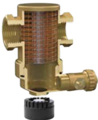
Vysoko výkonný magnet Exferro Easy Clip pre mosadzný exdirt. Intenzita magnetického poľa má maximálny účinok na tekutinu v separátore a umožňuje optimálne oddelenie častíc feromagnetických nečistôt, napríklad magnetit.
