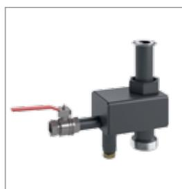
Údržbový box, vhodný pre všetky malé rozdeľovače 80/60 ako doplnkové príslušenstvo k magnetickému odlučovaču s hrdlami G 1 1/2". Skladá sa z profilovej rúrky 80x60, materiál S235, pripojenie 2x G1 1/2". Ďalej je box vybavený odkalovacím nátrubkom, guľovým kohútom 1/2" a magnetickou tyčou naskrutkovanou v jímke.
