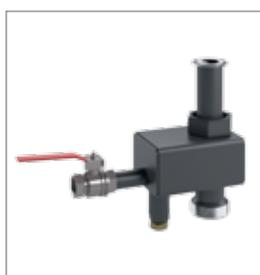
Údržbový box, vhodný pre všetky malé rozdeľovače 120/80 ako doplnkové príslušenstvo k magnetickému odlučovaču s hrdlami 1x horné Rp 2", 1x dolné R 2". Skladá sa z profilovej rúrky 120x80, materiál S235, pripojenie 1x hore Rp 2", 1x dole R 2". Ďalej je box vybavený odkalovacím nátrubkom, guľovým kohútom 1/2" a magnetickou tyčou naskrutkovanou v jímke.
