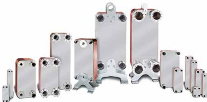
Reflex Longtherm sú nerezové meďou spájkované výmenníky tepla. Vďaka rozsiahlemu sortimentu rôznych typov sú použiteľné v širokej škále aplikácií od vykurovacej techniky, diaľkového vykurovania priemyselných závodov až po systémy chladenia. Maximálna prevádzková teplota je do 195 °C a maximálny trvalý prevádzkový tlak 30 barov.
