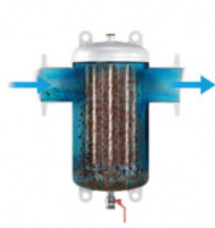
Exdirt Staal functievoorbeld
