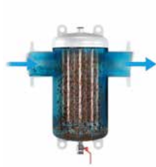
Exdirt R schéma
