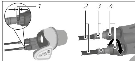
Sl.: Zazor omotača čeličnog užeta mjenjača (lijevo)
