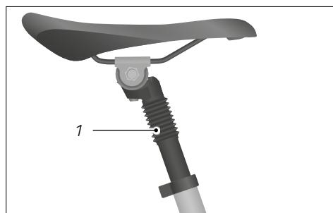
*Sl.: Cijev sjedala s oprugom (kao pri Ako je uz bočni dio gume na obruču naveden i tlak u gumi, maksimalni tlak u gumi gume jednak je manjoj od dvije vrijednosti. mjer)*
