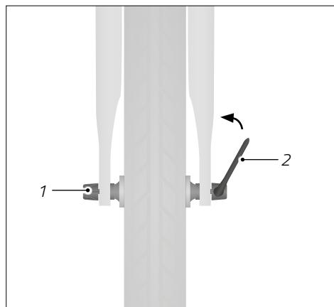
Sl.: Kotač s brzosteznom osovinom (kao primjer)
