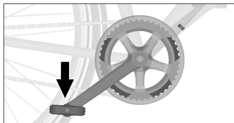
Sl.: Aktiviranje torpedo kočnice (kao primjer)
