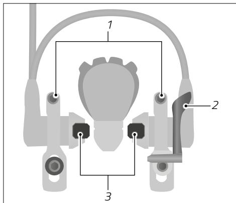
Sl.: Hidraulička kočnica obruča kotača (kao primjer)
