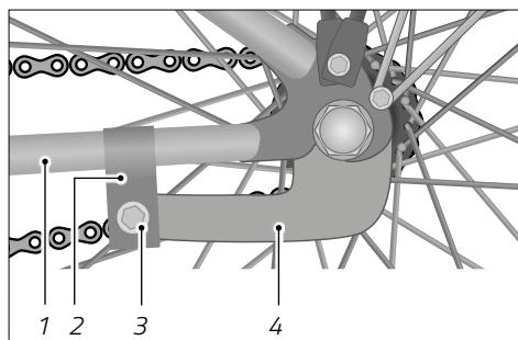
Sl.: Torpedo kočnica (kao primjer)
