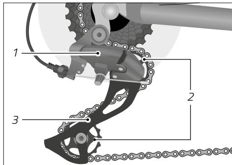
Sl.: Pokretne komponente mjenjača s lančanicima (kao primjer)
