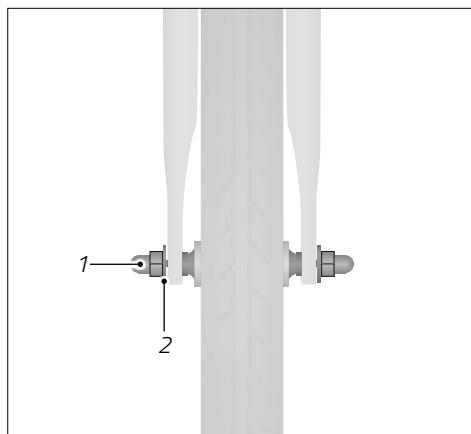
Sl.: Kotač s vijčanom osovinom (kao primjer)
