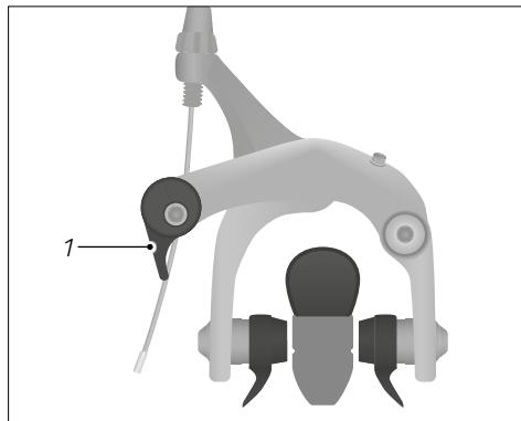
*Sl.: Priprema kočnice kod trkačih bicikala
