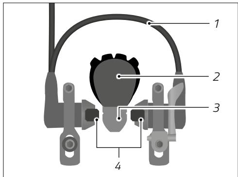
Sl.: Hidraulična kočnica obruča kotača (kao primjer)
