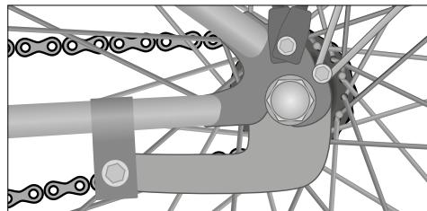
Sl.: Torpedo kočnica (kao primjer)
