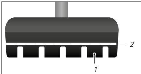
Sl.: Kočna papuča s indikatorom istrošenosti
