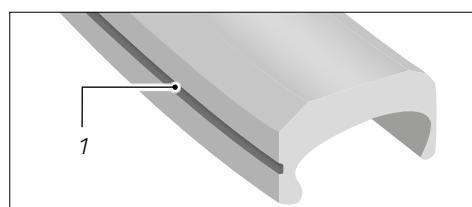
Sl.: Obruč kotača s indikatorom istrošenosti (kao primjer)
