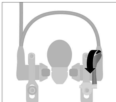
Sl.: Priprema kočnice kod hidrauličnih kočnica obruča kotača (kao primjer)
