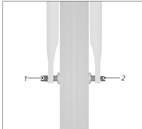
Sl.: KOTAČ S UTIČNOM OSOVINOM (KAO PRIMJER)
