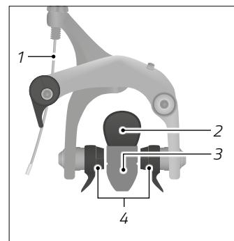
Sl.: Mehaničke kočnice obruča kotača (kao primjer)
