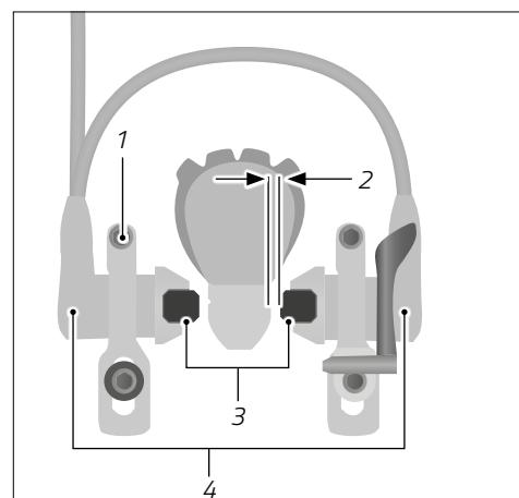
Sl.: Hidraulička kočnica obruča kotača (kao primjer)
