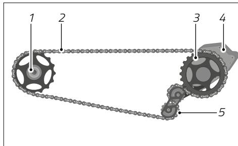
Sl.: Prijenosnik Pinion s lančanim pogonom
