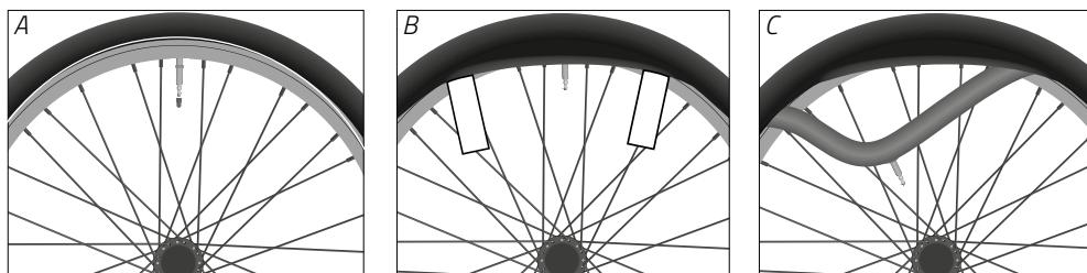
Sl.: Demontaža gume sa žicom ili gume ojačane kevlar vlaknima (kao primjer)
