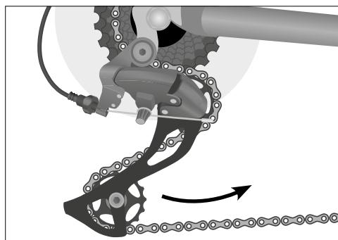
Sl.: Zatezač lanca na stražnjem kotaču
