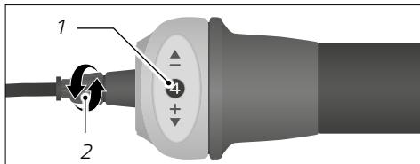
Sl.: Vijak za namještanje na okretnoj ručici mjenjača (kao primjer)
