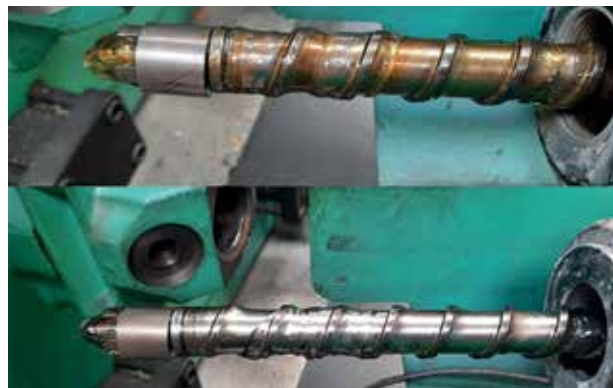
Schneckenbelag nach der Verarbeitung von Polyketon vor und nach der Reinigung mit AF-Clean® für Polyketon
