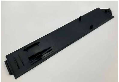
PA 6 GF 30 mit einer reduzierten Dichte von 37 %, geschäumt mit 4 % eines maßgeschneiderten AF-Complex® Treibmittel für Polyamide im Negativprägeverfahren.
