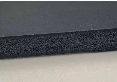
PA 6 GF 30 mit einer reduzierten Dichte von 37 %, geschäumt mit 4 % eines maßgeschneiderten AF-Complex® Treibmittel für Polyamide im Negativprägeverfahren.
