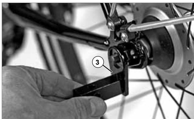
4. Alignez la roue arrière et serrez l'écrou d'axe de roue au couple indiqué dans le mode d'emploi du vélo tracteur. Dans le même temps, maintenez l'attache universelle en place.
