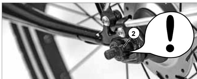
2. Laissez la rondelle existante sur l'axe plein et vissez la fixation sur axe (3) sur l'axe plein à la place de l'écrou retiré.
