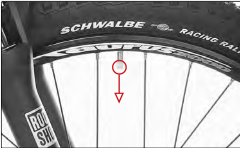
Ventil zeigt zum Laufradmittelpunkt
