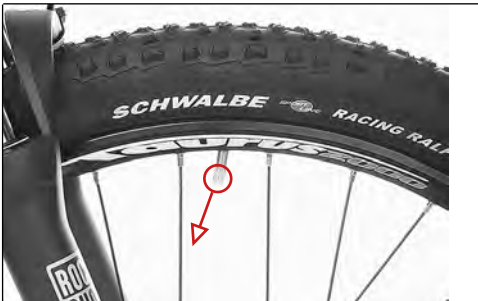
Ventil zeigt nicht zum Laufradmittelpunkt
