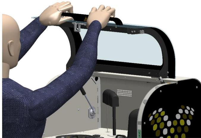
**Figure 13: Fermeture du couvercle principal**
