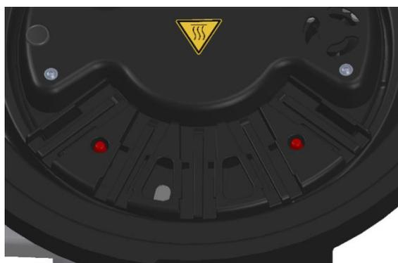
Figure 34: Position correcte des trous de segment et des goupilles (surlignés en rouge)
