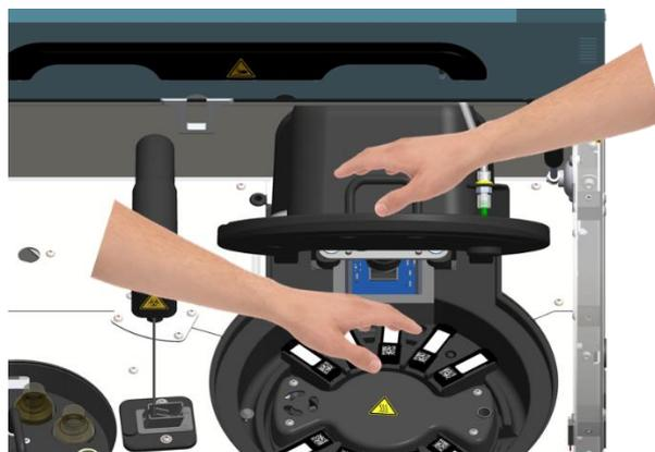
**Figure 32: Fonctionnement à deux mains du rotor de la cartouche**
