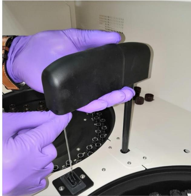
4. Vissez doucement une nouvelle aiguille en acier dans le support en la tournant dans le sens des aiguilles d'une montre jusqu'à ce qu'elle soit fixée. Serrez fermement et assurez-vous qu'il reste un espace entre le boîtier et la poignée après le serrage (voir XVI.7).
