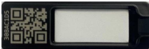
Placer la cartouche ConfigXplorer dans le rotor de l'instrument. Le ConfigXplorer doit toujours être placé en position 1 dans le rotor de la cartouche. La position 1 (indiquée par la flèche sur l'image ci-dessous) est située dans le sens inverse des aiguilles d'une montre par rapport à l'orifice de vidange cylindrique du rotor de la cartouche. Le rotor peut être déplacé manuellement dans les deux sens lorsque le couvercle supérieur est ouvert.
