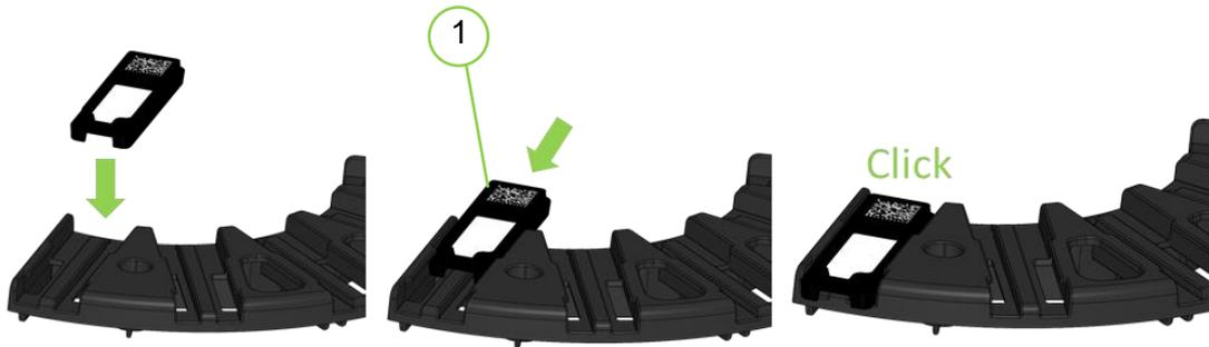
Figura 32: Esquema de carga del cartucho en el segmento
