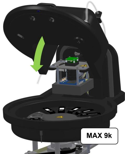
Asegúrese de que se han retirado todos los tapones de los frascos de reactivos y de los tubos de muestras. **Cierre manualmente la tapa superior principal del aparato.**
