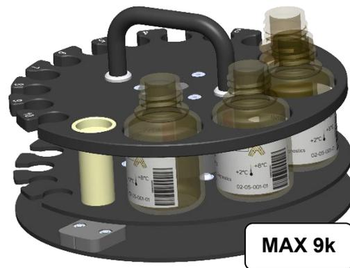
Si utiliza el kit 20x ALEX<sup>2</sup> con el dispositivo MAX 9k, aplique los adaptadores estrechos para las botellas de reactivos correspondientes, como se indica a continuación.
