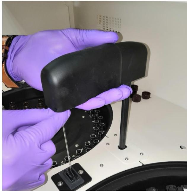
4. Enrosque suavemente una nueva aguja de acero en el soporte girándola en el sentido de las agujas del reloj hasta que quede fija. Apriételo firmemente y asegúrese de que aún queda espacio entre el alojamiento y la empuñadura después de apretar (véase XVI.7)
