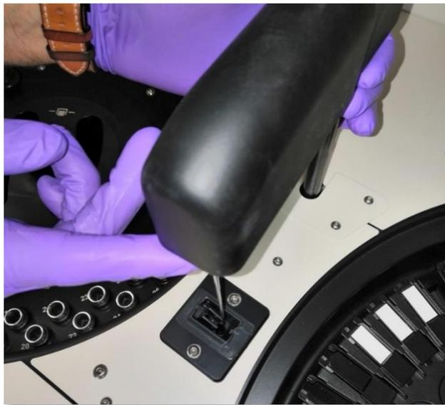
3. Sujete el brazo en la posición mencionada y desenrosque la aguja lentamente girándola en sentido contrario a las agujas del reloj con la otra mano. El líquido caerá en el canal de desagüe. Asegúrese de que sólo toca la aguja en su empuñadura (véase XVI.7).
