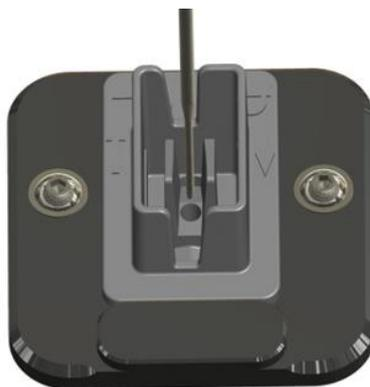
6. En caso de que la aguja toque una de las dos paredes laterales, póngase en contacto con su distribuidor local o con el servicio de asistencia MADx.
