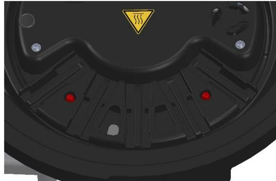
**Figura 35: Posición correcta de los orificios de los segmentos y los pasadores (resaltados en rojo)**
