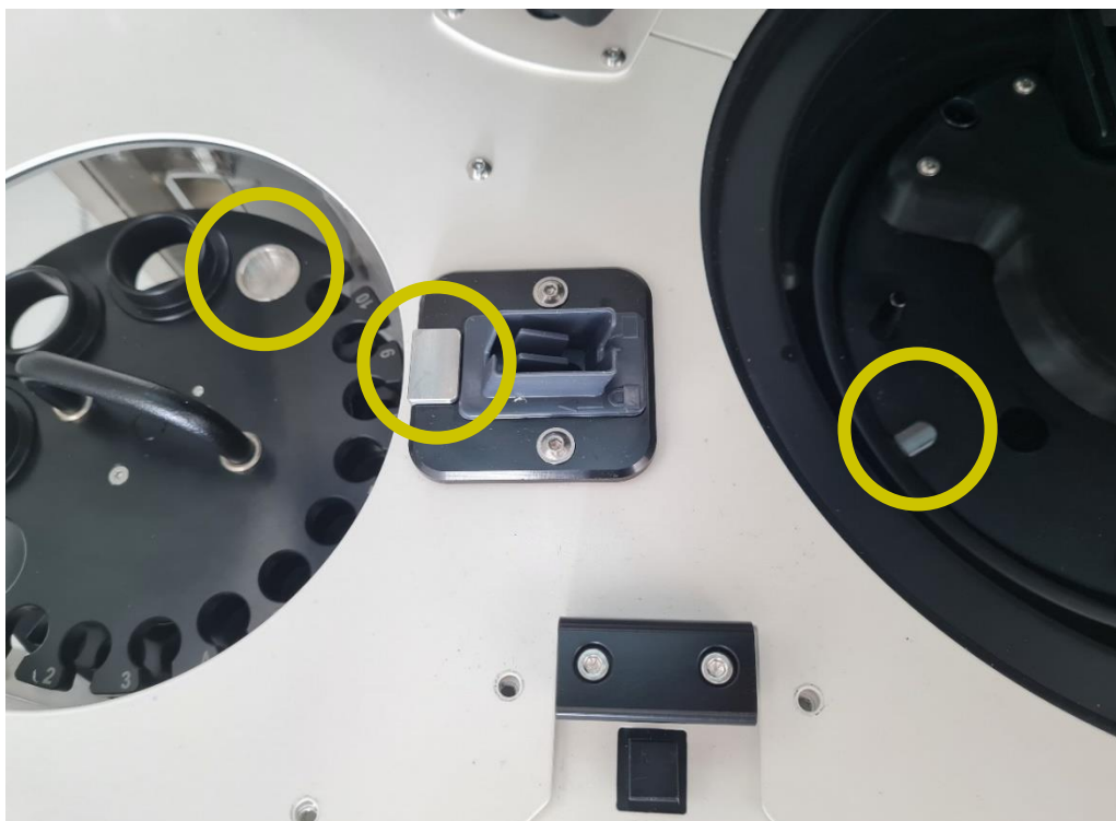
Obrázek 52: Kovové seřizovací přípravky se čistí 70% etanolem v přístroji MAX 9k
