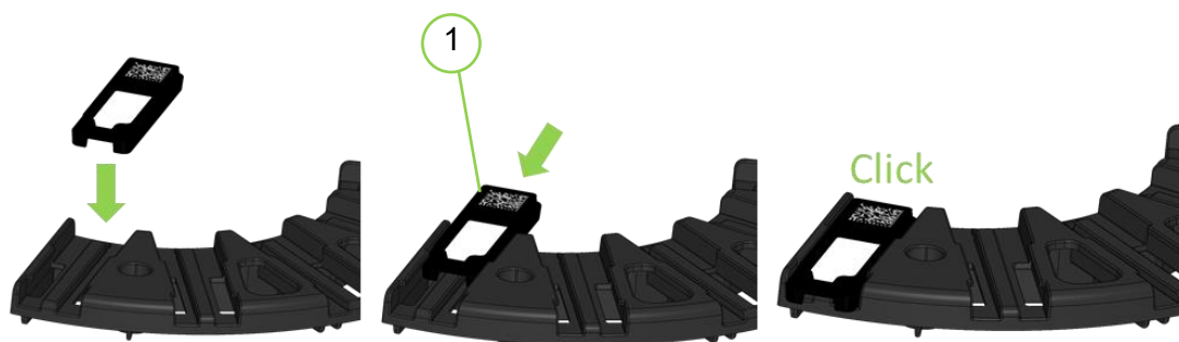
Obrázek 32: Schéma vkládání kazety do segmentu
