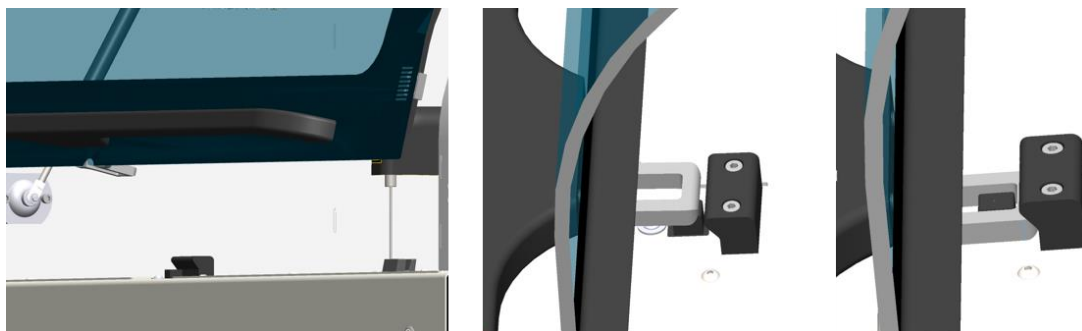
Obrázek 12: Znáznornění funkce blokování hlavního krytu
