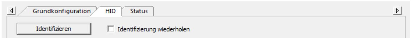
Hier können Sie die Adresse der Notleuchte direkt über die Status-LED am Gerät anzeigen lassen. Dafür wird die Adresse in eine sechsstellige Binärzahl umgewandelt, die als Blinkmuster wiedergegeben wird. Die rote LED steht für die Binärzahl 0, die grüne LED für die Binärzahl 1.
