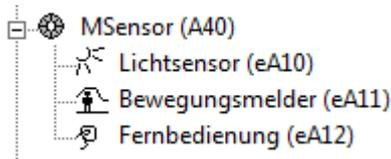
Der DALI MSensor 02 besteht intern aus drei Geräteklassen, die im DALI-Gerätebaum einzeln gelistet sind:
