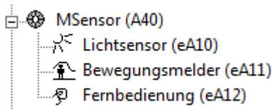
Der MSensor 5DPI 14 besteht intern aus drei Geräteklassen, die im DALI-Gerätebaum einzeln gelistet sind:
