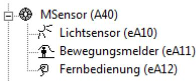
Der DALI MSensor besteht intern aus drei Geräteklassen, die im DALI-Gerätebaum einzeln gelistet sind:
