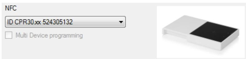
Aktivieren Sie die Checkbox **Multi Device programmierung**, wenn mehr als ein Treiber gleichzeitig programmiert werden soll.
