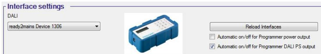
Mit dem ready2mains Programmierer ist es möglich, die Ausgangsleistung und das DALI PS ein- oder auszuschalten. Beide Optionen können in den Schnittstelleneinstellungen aktiviert werden:
