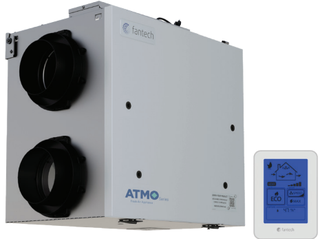
ATMO VRC/VRE Apporter de l'air frais, éliminer l'air vicié; air tempéré par l'air sortant Ventilation de salle de bain Le minuteur sans fil active l'appareil d'air frais pour une ventilation à la demande ECO-Touch IAQ Augmente la ventilation en fonction des TVOCs (Composés Organiques Volatils Totaux) Autre extraction L'air vicié extrait des zones nécessitant une ventilation locale (salle de bain, cuisine, buanderie, etc.)
