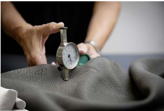
O BEN: Qualitätscheck – vor dem Zuschnitt prüft der Stärkenmesser, ob das Leder dick genug ist. 45 Prozent der Kunden entscheiden sich für Leder, 55 Prozent für Stoff
