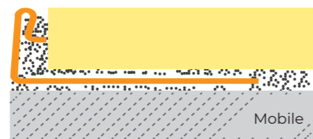
Vista di sezione trasversale di un profilo Schlüter®-Schiene-E
