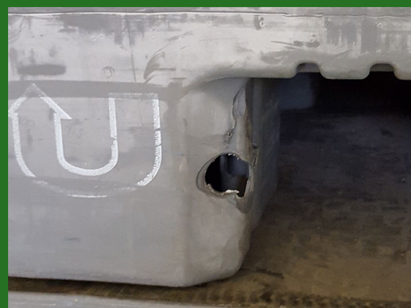
Pall med hål upp till 3,5 cm räknas som godkänd.
