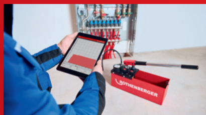
Digital trycksensor möjliggör exakt justering av testtrycket
