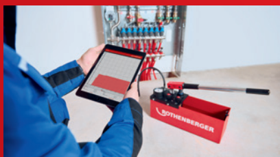
Digitaalinen paineanturi mahdollistaa tarkan koepaineen säädön
