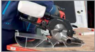
Cobre, plástico, aço carbono, ferro fundido ou aço inoxidável podem ser cortados até um diâmetro de tubo de 110 mm
