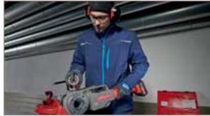
Fácil inserção da cabeça de rosca com anel de travamento de tensão
