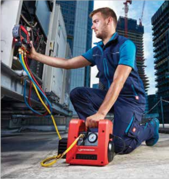
ROAIRVAC R32 1.5 - bomba de vácuo em uso com o coletor digital ROCOOL 600
