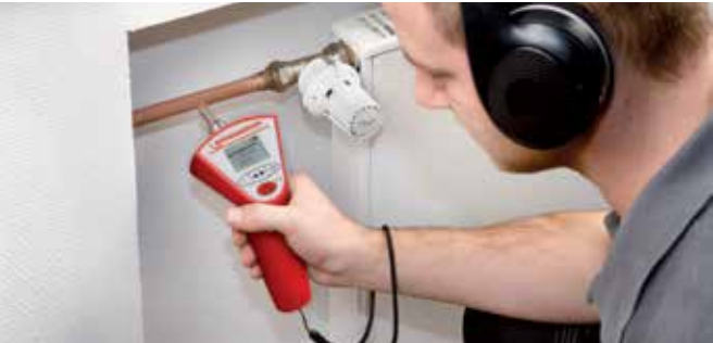
Detecção acústica de fugas em instalações de aquecimento
