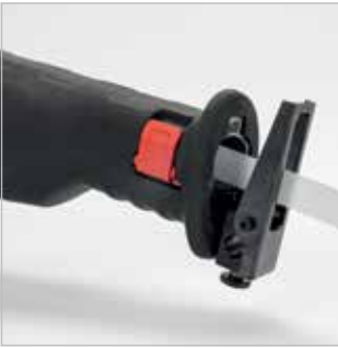
Troca da lâmina de serra por engate rápido - além disso, topo rotaciona 180° para um trabalho confortável
