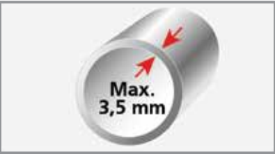
Espessura da parede até 3,5 mm
