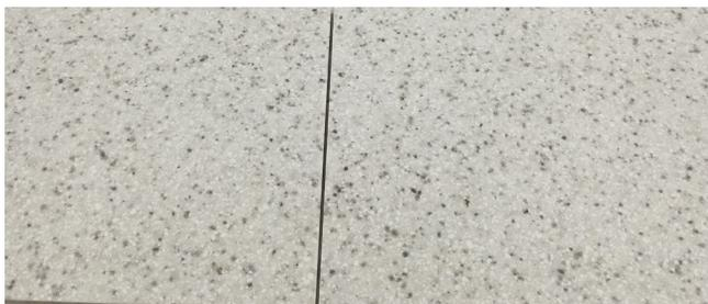
在表面上部划出纹路，可增强额外粘合剂的粘合力。这有助于防止在机加工过程中，接缝的关键上层被拉出。
