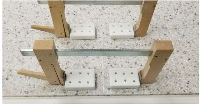
待粘合剂固化后，涂上异丙醇，稍等片刻让热熔胶软化，然后移除胶块。同时，将异丙醇涂抹到 1/4" (6.3 mm) 的孔中，使其渗入胶块中心。接着，将凿子放在胶块的斜角边下方，轻轻撬起；避免过度用力。如果胶块没有立即松动，可以再涂抹一些异丙醇，浸泡一段时间。
