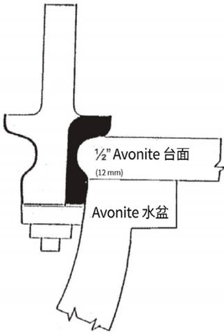
用于铣削 AVONITE™ 台下盥洗盆和厨房水槽的牛鼻边铣刀, 配备 VEL-VET TOUCH™ 轴承导向装置, 刀柄直径为 1/2" (12 mm) - 双刃设计
