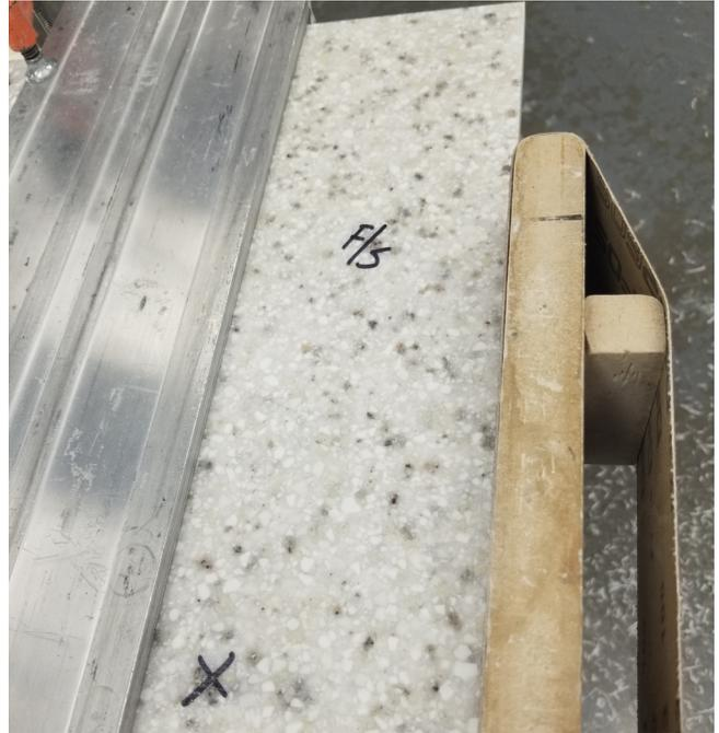
在硬木块上使用 100 目砂纸，轻轻打磨需要接合的边缘，这有助于增强两个表面之间的粘合力。只需打磨一到两遍。注意不要打磨顶部边缘。
