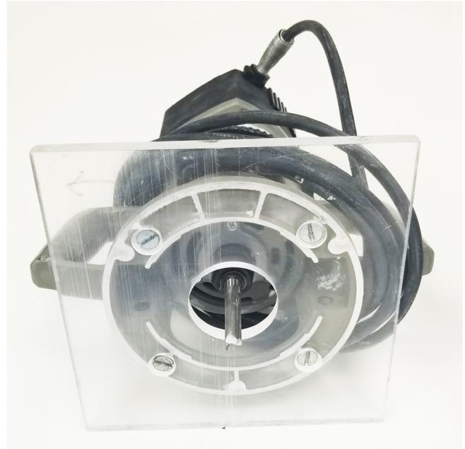
应使用优质的 1-1/2 – 2 HP 电木铣。重新装配为方形底座。底座上的两个操作方向可用于转动底座并额外切除 1/16" (1.5 mm)。必须使用 1/2" (12.7 mm) 双刃硬质合金铣刀。
