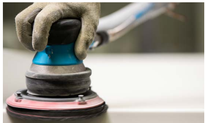
La pulidora debe ser de una velocidad variable de entre 1.000 - 3.000 RPM. Los mejores resultados se consiguen a las velocidades más bajas.
