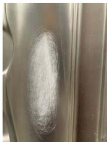
1. Etwa 10-15 Sekunden langes Nassschleifen mit 3M Trizact rot, Reinigung mit einem feuchten Tuch, bevor mit dem nächsten Schritt fortgefahren wird.
