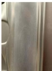
4. Etwa 10-15 Sekunden langes Nassschleifen mit 3M Trizact orange, Reinigung mit einem feuchten Tuch, bevor mit dem nächsten Schritt fortgefahren wird.
