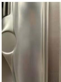
6. Verwenden Sie etwa 10-15 Sekunden lang ein feuchtes 3M Gray Scotch-Brite-Pad, Reinigung mit einem feuchten Tuch, bevor Sie mit dem nächsten Schritt fortfahren.
