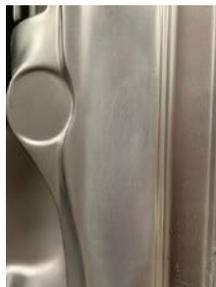
3. Etwa 10-15 Sekunden langes Nassschleifen mit 3M Trizact blau, Reinigung mit einem feuchten Tuch, bevor mit dem nächsten Schritt fortgefahren wird.
