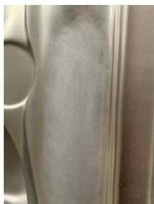
2. Etwa 10-15 Sekunden langes Nassschleifen mit 3M Trizact grün, Reinigung mit einem feuchten Tuch, bevor mit dem nächsten Schritt fortgefahren wird.
