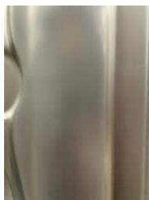
7. Verwenden Sie so lange wie nötig, etwa 5-10 Sekunden, ein feuchtes 3M White Scotch-Brite-Pad, um das passende Finish zu erzielen. Wenn es zu sehr glänzt, mit Gray Scotch-Brite wiederholen und mit White Scotch-Brite so lange nachpolieren, bis der Glanz mit dem der übrigen Platte übereinstimmt.
