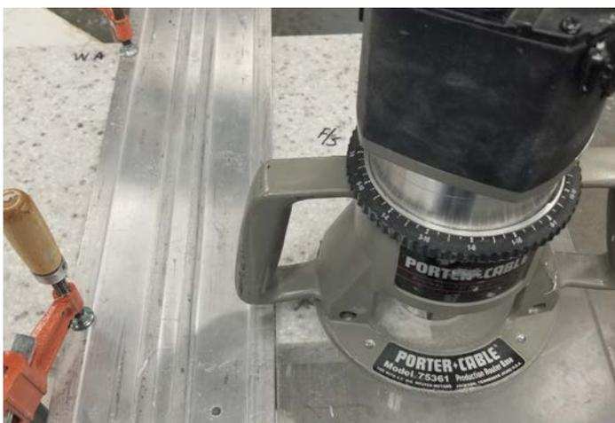
Richten Sie die Oberfräse eben an einer Führungsschiene aus. Bewegen Sie die Fräse mit gleichmäßiger Vorschubgeschwindigkeit. Achten Sie auf den Klang der Oberfräse als Indikator für den Vorschub.
