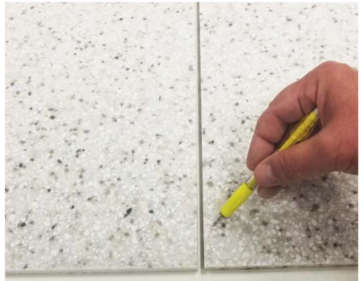
Nach dem Fräsen der Kanten fügen Sie die Teile probeweise zusammen, um eine ebene, richtige Kante zu gewährleisten. Bei diesem Vorgang sollte die Fugenahnt nahezu verschwinden. Ist die Fugenahnt nicht korrekt, nehmen Sie weitere 1,5 mm (1/16") ab. Prüfen Sie durch erneutes, probeweises Zusammenfügen.
