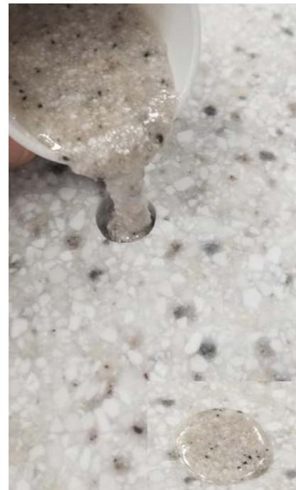
Es ist schwer, das Reparaturmaterial auf den gleichen Glanz zu bringen, wie die Platte mit poliertem Finish. Eine 100-Watt-Glühlampe zur Erwärmung der Reparaturstelle wirkt unterstützend. Größere Bereiche sollten mit einem passenden Einsatz aus Mineralwerkstoff repariert werden.
