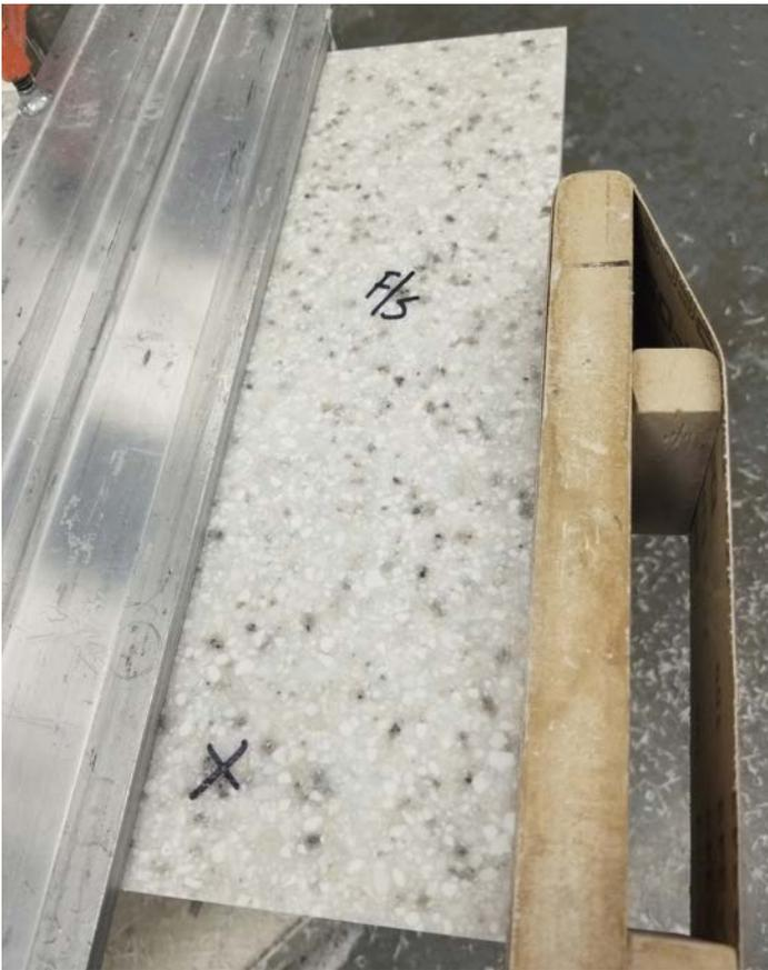
Rauen Sie die zusammenzufügenden Kanten mit Schleifpapier der Körnung 100 und einem Hartholzklötz leicht auf. Dieser Schritt unterstützt die Haftung zwischen den beiden Flächen. Machen Sie nur ein bis zwei Durchgänge. Achten Sie darauf, dass Sie nicht die obere Kante schleifen.
