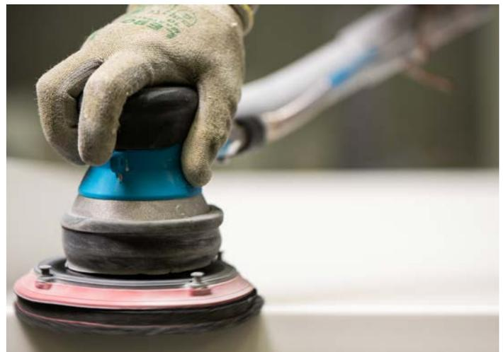
*Die Poliermaschine sollte eine variable Drehzahl zwischen 1.000 - 3.000 min<sup>-1</sup> haben. Die besten Ergebnisse werden bei niedrigen Geschwindigkeiten erzielt.*
