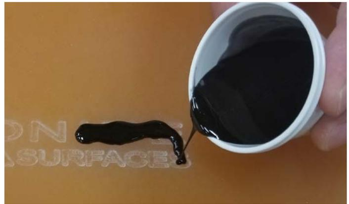
Lassen Sie das Ganze gründlich austrocknen und führen die Endbearbeitung durch. Die Aushärtungszeit beträgt etwa 8 Stunden.
