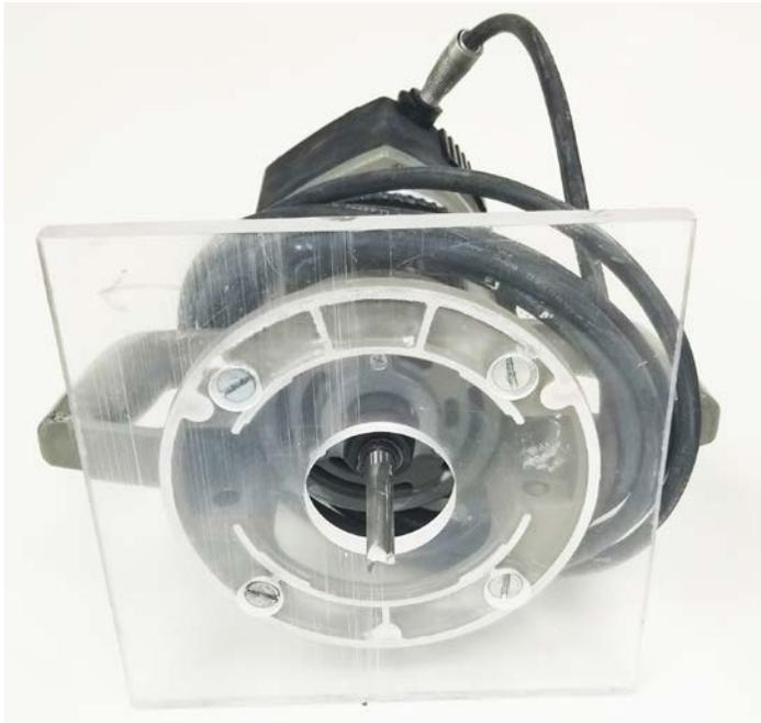
Verwenden Sie eine hochwertige Oberfräse mit einer Leistung von 1,2 - 1,5 kW (1,5 bis 2 HP). Statten Sie den Fuß mit der rechtwinkligen Grundplatte aus. Aufgrund ihrer beiden Maße kann die Grundplatte gedreht und zusätzliche 1,5 mm (1/16") entfernt werden. Verwenden Sie stets einen zweischneidigen Hartmetallfräser mit 12,7 mm (1/2") dicken Schaft.
