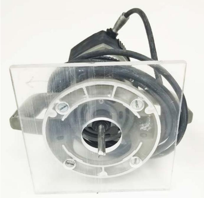
Utiliser une défonceuse 1-1/2 - 2 CV de bonne qualité. Habiller la base d'une embase carrée. Les deux dimensions de l'embase permettent de la tourner afin de retirer 1,5 mm (1/16") supplémentaires. Toujours utiliser une fraise en carbure à deux flûtes de 12,7 mm (1/2").
