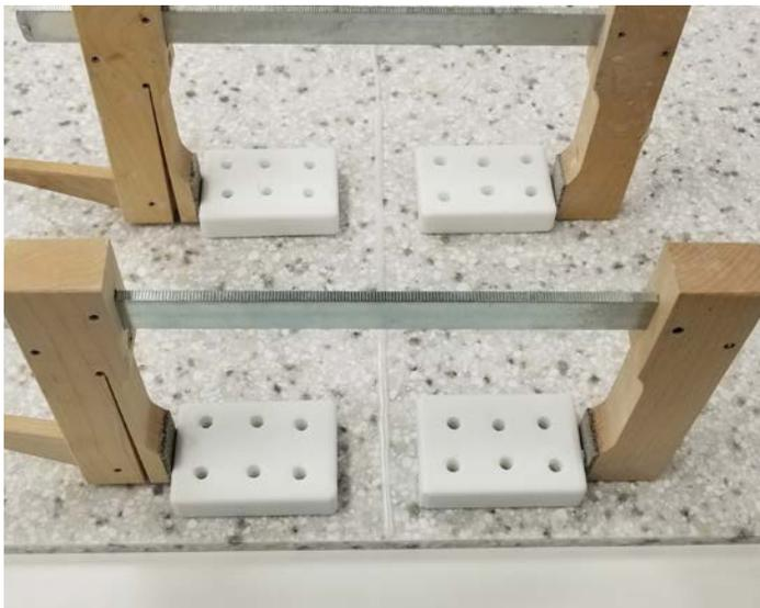
Une fois la colle durcie, retirer les blocs en appliquant de l'alcool isopropylique et laisser le temps à la colle thermofusible de ramollir. Appliquer également de l'alcool dans les trous de 6,3 mm (1/4") afin de lui permettre de pénétrer au centre du bloc. Placer ensuite un burin sous le bord biseauté du bloc et forcer légèrement, sans utiliser de force excessive. Si le bloc ne se libère pas immédiatement, appliquer davantage d'alcool et laisser tremper plus longtemps.
