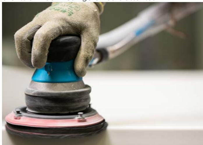
Le polissoir doit être à vitesse variable de 1000 à 3000 tr/mn. Les meilleurs résultats sont obtenus à des vitesses inférieures.
