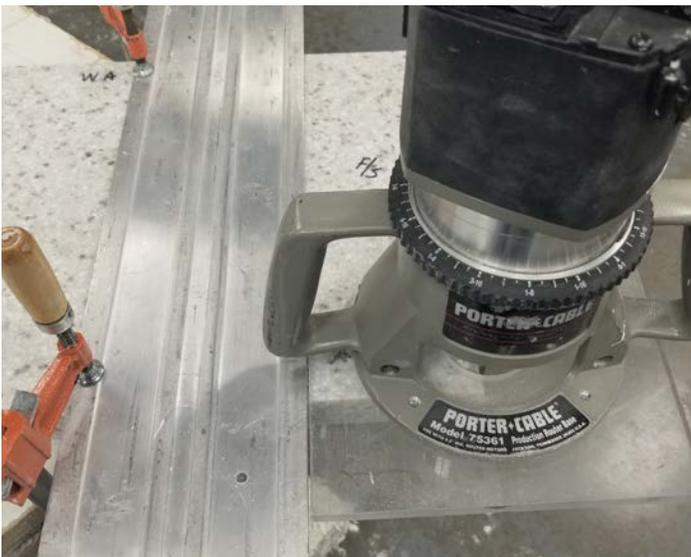
Placer la défonceuse à plat contre un bord droit. Déplacer la défonceuse à une vitesse régulière. Repérer la vitesse d'avance au son de la défonceuse.
