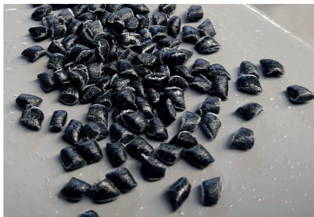
Bild 1. Für die Versuche wurde aus Organoblech-Verschnittabfällen auf Basis von UD-Tapes (links) ein Regranulat (rechts) hergestellt © PureLoop
