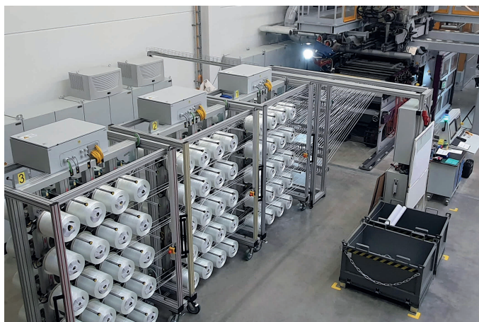
Bild 2. Das für die Versuche eingesetzte Composite-Material wurde von Profol aus Glasfasern und Polypropylen produziert © Profol
