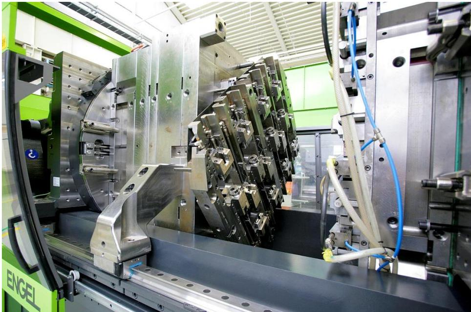
*Imagen 2: Gracias a su tecnología sin barras, la serie ENGEL victory ofrece mucho espacio para moldes grandes y automatizaciones amplias. Gracias al gran tamaño de la platina, a menudo no es necesario invertir en una máquina más grande.*
