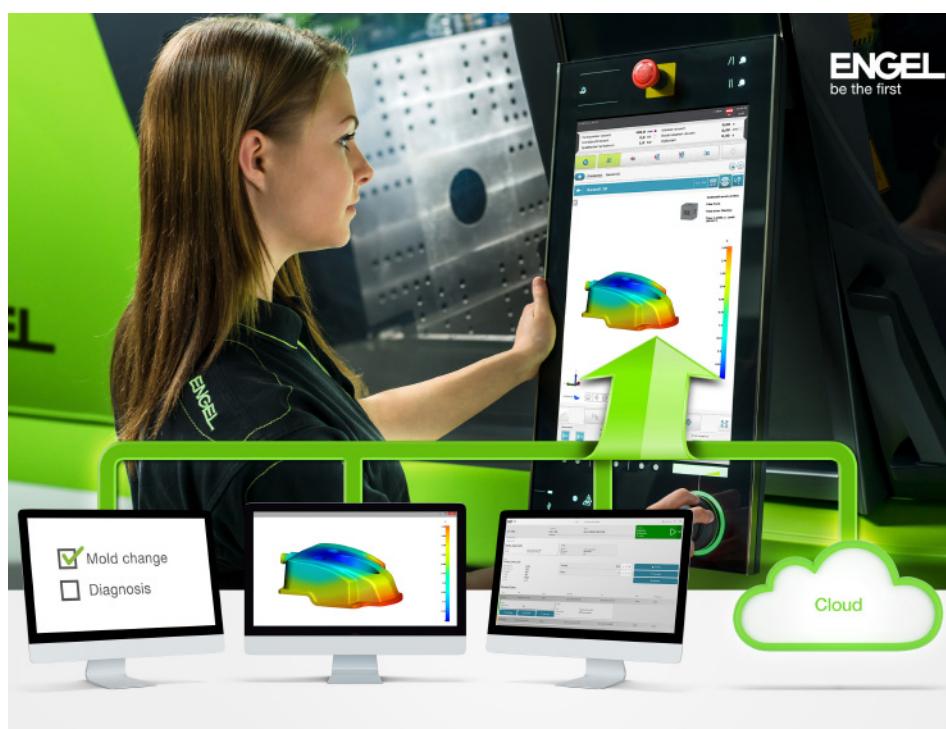
Webviewer w sterowniku maszyny integruje urządzenia peryferyjne z interfejsami sieciowymi, a także dane z systemów wewnętrznych i zewnętrznych, które są dostępne poprzez przeglądarkę.
