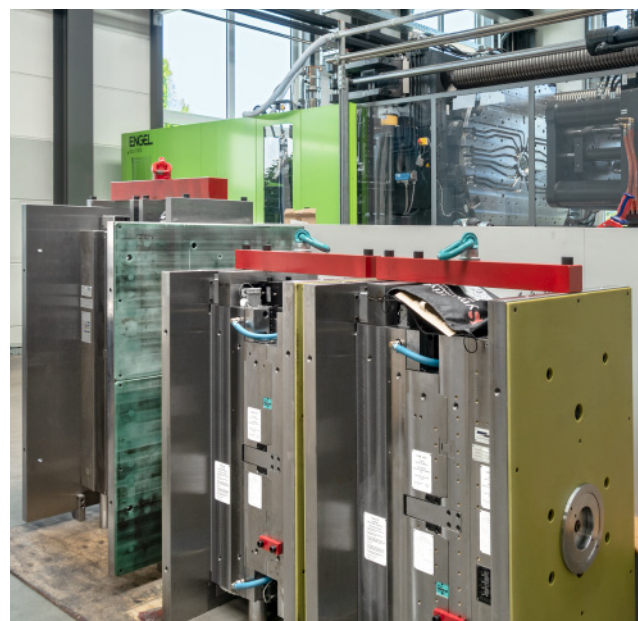
Dzięki stołowi i talerzowi obrotowemu maszyna duo combi M jest bardzo dobrze wyposażona do najszybszych wymagań wielokomponentowych.
