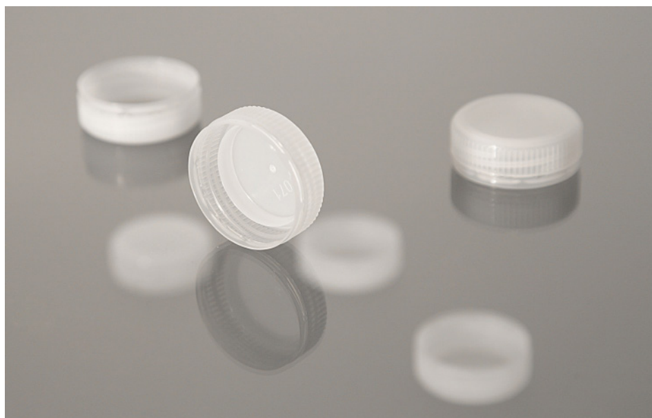
Przy produkcji zakrętek 29/25 na wtryskarce ENGEL e-cap w 96-krotnej formie, dzięki iQ weight control ponad dwukrotnie zwiększono stabilność procesu. Czas cyklu pozostał taki sam. Wynosi mniej niż 2 sekundy.
