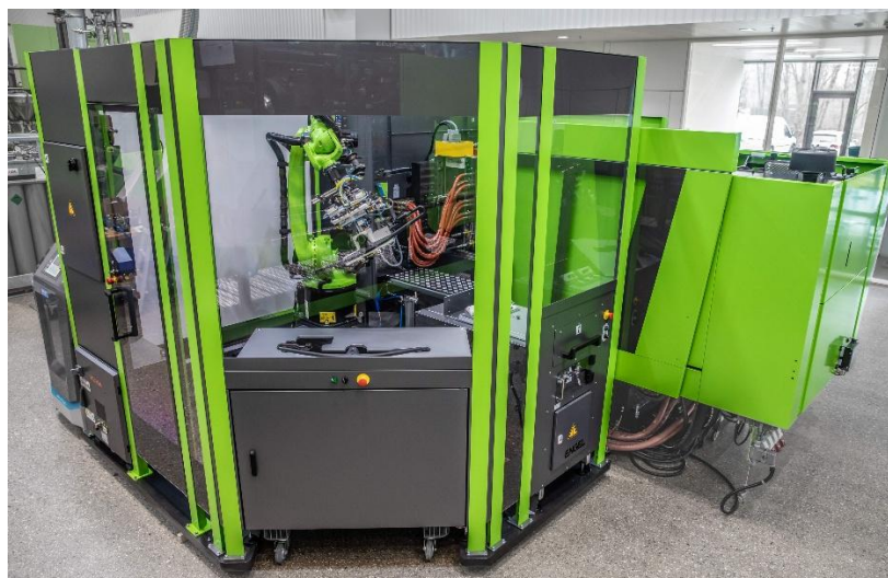
Imagen 2: El robot easix en acción: los robots de seis ejes easix de ENGEL destacan por su gran flexibilidad y su diseño compacto, que los hace ideales para realizar tareas de automatización complejas en espacios limitados.
