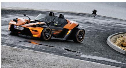
Фото 7. Панель с несущим слоем из углеродного волокна для спортивного автомобиля X-Vow, изготовленная по технологии HP-RTM
