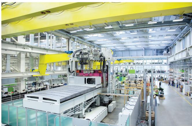
Фото 8. Завод больших литейных машин ENGEL в г. Санкт-Валентине (Австрия): процесс сборки литейной машины ENGEL v-duo 3600, предназначенной для поставки компании BMW
