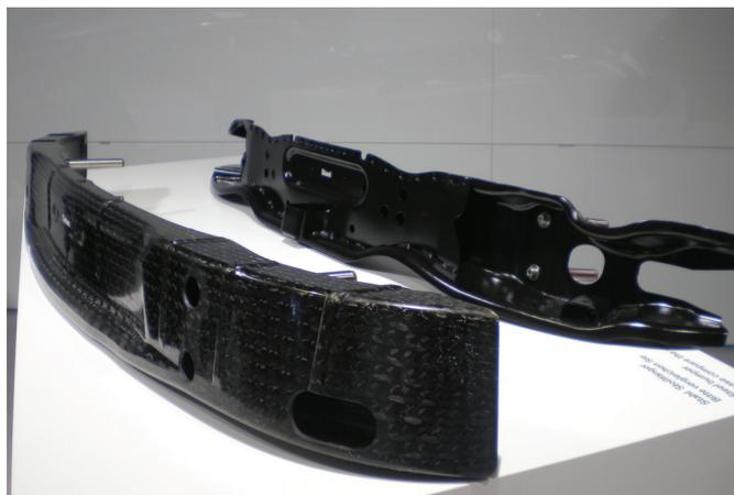
Задача снижения массы транспортных средств, особенно важная для электромобилей, наиболее эффективно решается за счет замены их металлических элементов на композитные. Примером служит несущая часть бампера, изготовленная из углепластика взамен металлического аналога
