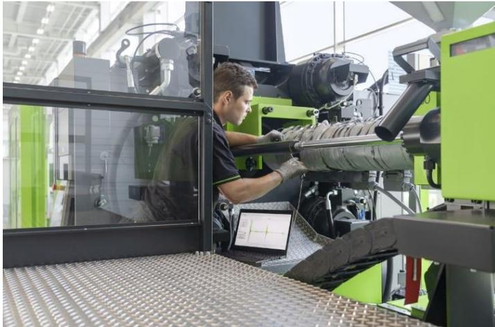
Abrieb an den Stegen der Schnecke beeinflusst die Qualität. e-connect.monitor ermittelt den Zustand der Schnecke, ohne die Plastifiziereinheit demontieren zu müssen.
