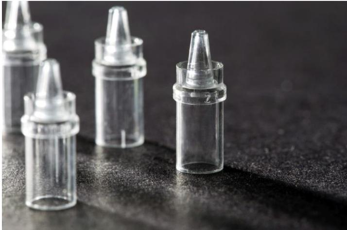
Die filigranen Nadelhalter haben ein Einzelschussgewicht von gerade einmal 0,08 g. Sie erfordern einen äußerst präzisen Spritzgießprozess
