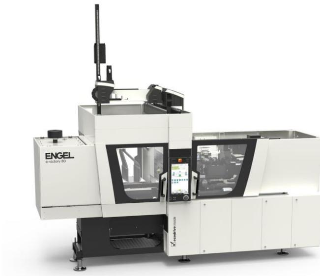
Die ENGEL e-victory Spritzgießmaschine kombiniert eine holmlose Schließereinheit mit einer elektrischen Spritzeinheit.
