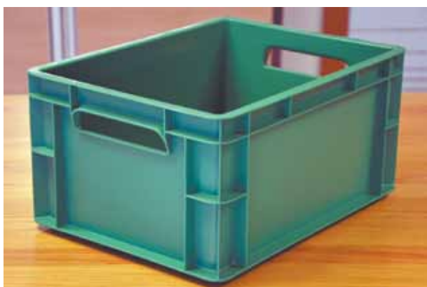
Фото 2. Большая литьевая машина ENGEL duo 3550/500 с интегрированным роботом viper (а), на которой изготавливались штабелируемые ящики из полипропилена (б)
