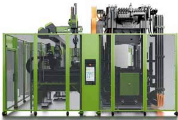
Фото 5. Сравнительно компактные и энергосберегающие машины серии ENGEL v-duo были разработаны компанией ENGEL специально для производства изделий из полимерных волокнистых композитов
