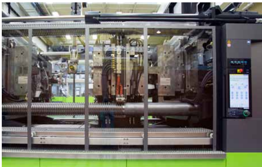
Фото 1. Машина ENGEL duo 650 combi M, оснащенная поворотной плитой и предназначенная для многокомпонентного литья под давлением. Технология ENGEL clearmelt позволяет одновременно перерабатывать термопласт и полиуретан
