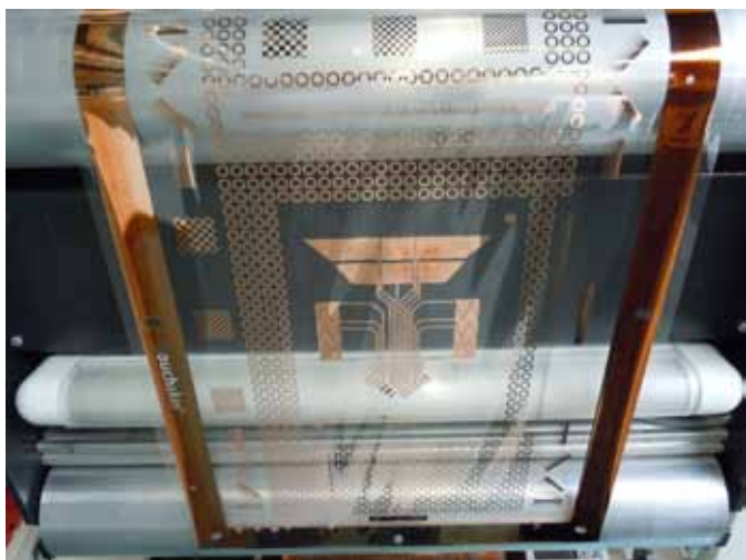
Фото 2. Многообещающим является использование технологии ENGEL clearmelt для литья на подложку с применением в качестве подложки электрочувствительной емкостной пленки. Кабина будущего не будет иметь кнопок и переключателей
