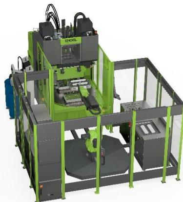
**Hochpräzise und kompakt:** Die ENGEL insert 150 zeigt auf der K 2025 eine voll automatisierte LSR-Anwendung zur Abdichtung von GDL-Folien für Brennstoffzellen.
