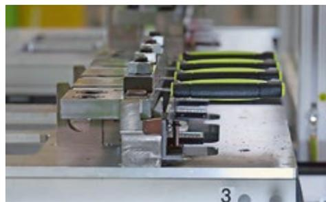
Bis zum Abschluss der Griffherstellung bleiben die Messer im Viererpack auf der Trägerleiste fixiert. Dann übernimmt wieder der große Mehrachsroboter.
