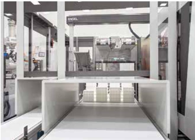
**Рис. 1.** Сначала гнездовые вставки из POM охлаждаются, перемещаясь на верхней U-образной конвейерной ленте, и штабелируются. Затем робот *vipec* принимает их и укладывает на большой нижний ленточный транспортер
