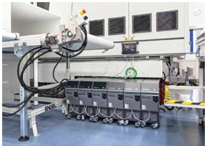
**Рис. 3.** Использование термостатов *e-temp* не только стабилизирует процесс термостатирования литьевых форм, но и значительно повышает его энергоэффективность
