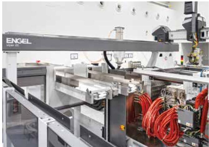
**Рис. 2.** Линейные роботы *vipec 20* выполняют две задачи: извлечение литьевых изделий из формы и их передачу в уже охлажденном состоянии на ленточный транспортер
