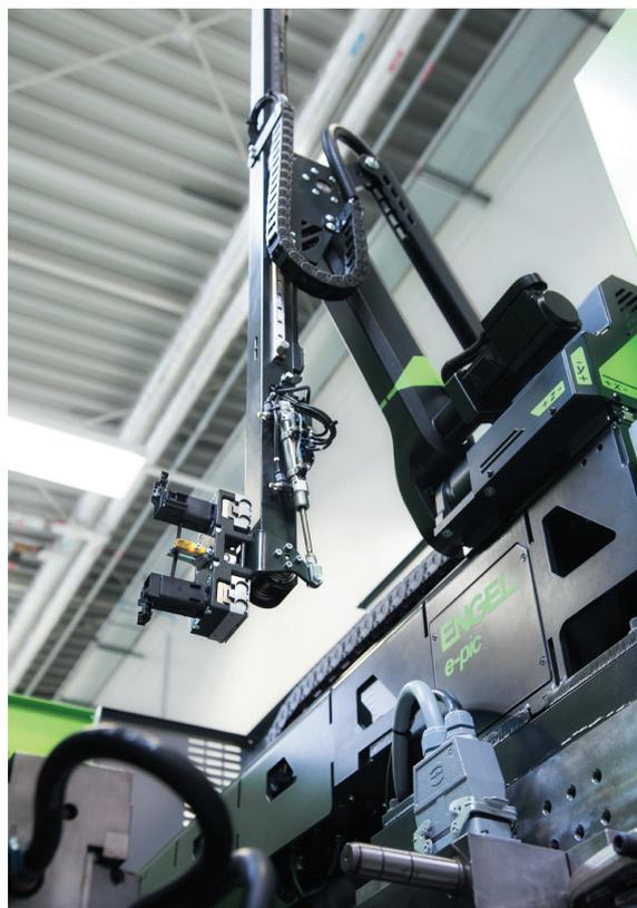
Фото 3. Опора оси Z робота ENGEL e-ric одновременно выполняет роль стойки. Благодаря возможности поворота робот автоматически приспосабливается к высоте литьевой машины без применения каких-либо дополнительных монтажных деталей
