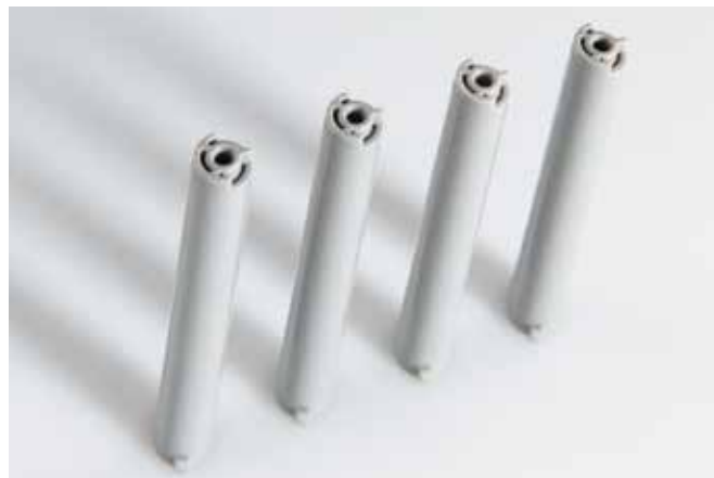
Пластиковые корпуса используемых в мебельной промышленности демпфирующих цилиндров, к литью под давлением которых предъявляются высокие требования из-за их сложной геометрии и типа материала
