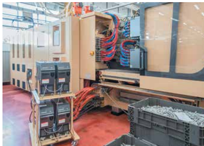
Рис. 3. Вид на бесколонную литейную машину e-victory 220 с обратной стороны: внизу слева – четыре термостата e-temp для многогнездной литейной формы
