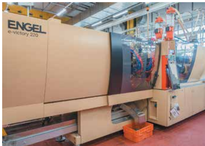
Рис. 2. Бесколонная электрическая литейная машина e-victory 220, на которой на заводе Blum в многогнездной форме производятся корпуса демпфирующих цилиндров из ПОМ для мебельной промышленности
