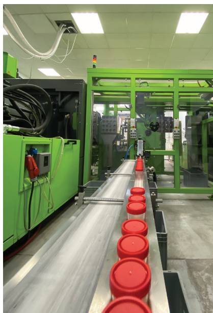
Автоматизированная литьевая ячейка на заводе «ПластиЛаб Индустрия» на базе бесколонного ТПА ENGEL victory позволяет быстро и эффективно осуществлять производство медицинских изделий
