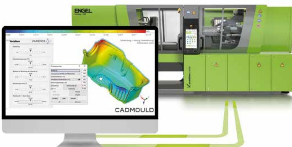
Sim link semplifica la collaborazione tra gli addetti alla simulazione e gli ingegneri di processo, combinando gli ambienti della simulazione con il mondo reale. In pratica, con Sim link Engel offre un'interfaccia per il programma di simulazione CadMould, messo a punto da Simcon
